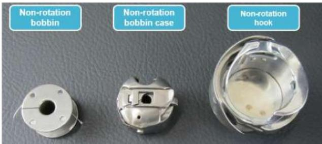
Crochet speciale senza la rotazione della bobina
